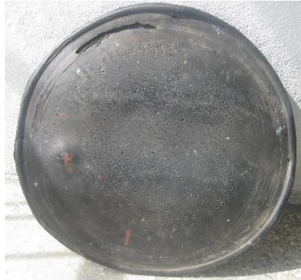
Figura 2.2: Diafragma de PTEF empleado en la bomba máster. Fuente: Elaboración propia.
