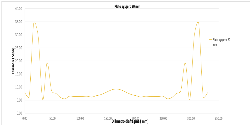
Figura 2.14: Valores de deformaciones del diafragma obtenidos en la simulación en conjunto con la placa de agujero único de 20mm. Fuente: Elaboración propia.
