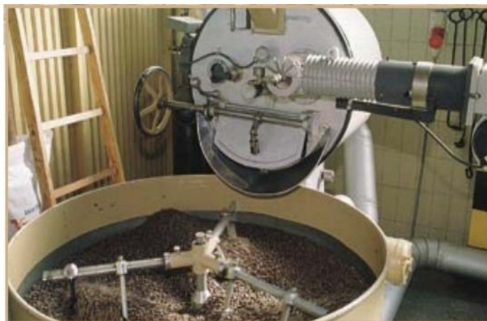
Figura No. 3.5. Cuna de enfriamiento
