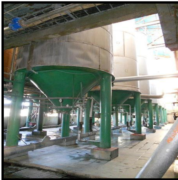
Figura 1.2: Baterías de cubas para la maceración de maíz. Fuente: Empresa Glucosa Cienfuegos.
