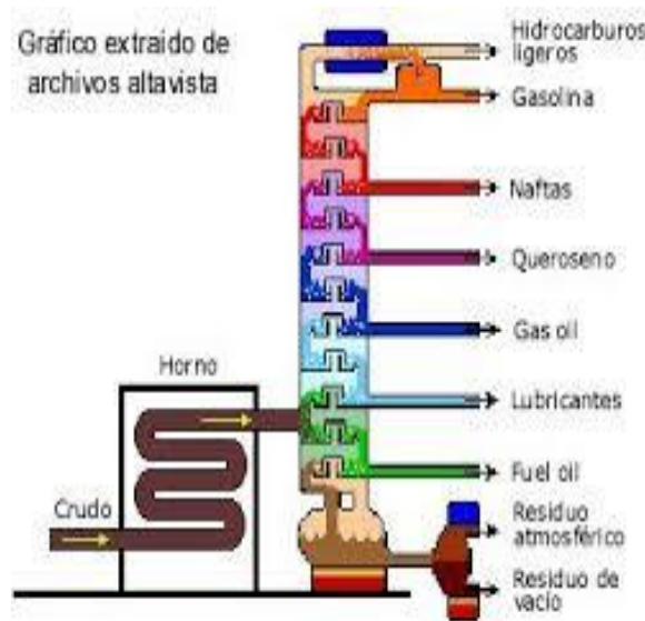
Figura 3.3. Esquema de una torre de destilación.
