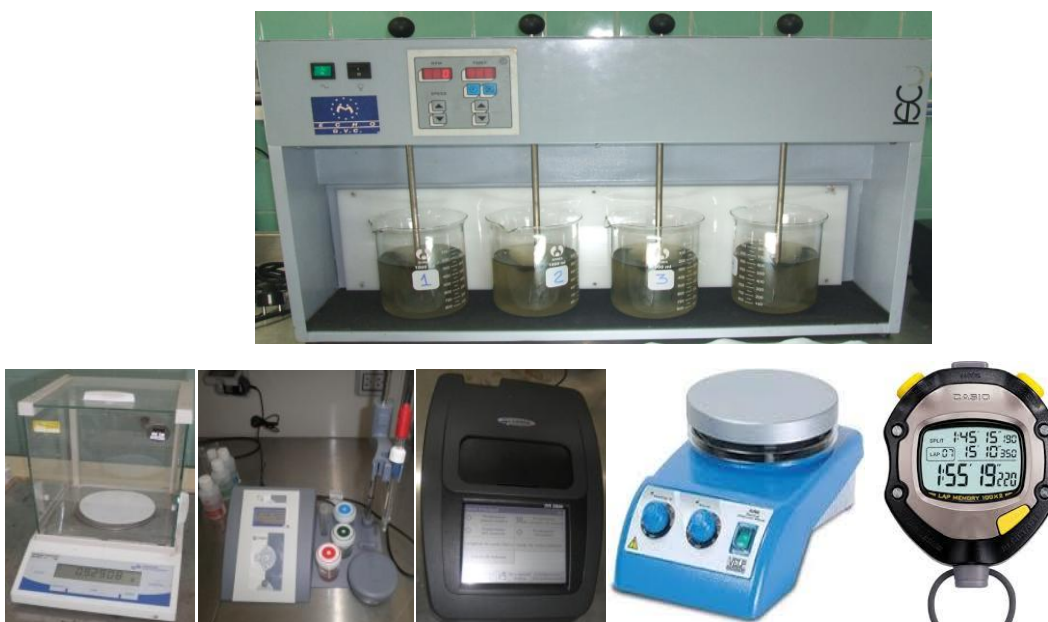
Figura 12. Equipos utilizados en las Pruebas de Jarras: Agitador Múltiple Programable, Balanza Digital, PH-metro y Espectrofotómetro DR-2800, Agitador Magnético y Cronómetro Digital.
