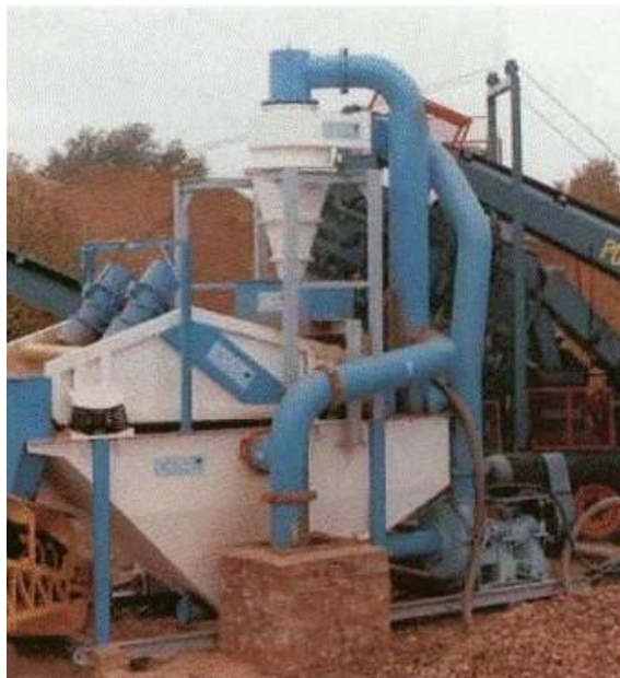
Figura 2.9 Ciclón de cono tendido ( \varnothing 750 mm) en una clasificadora de arena.
