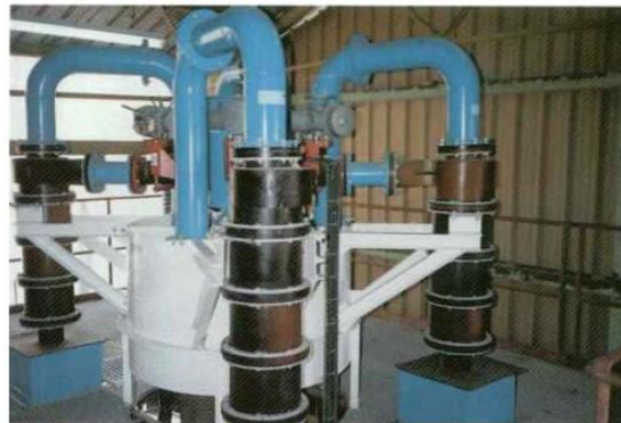
Figura 2.13 Ciclón cilíndrico AKW ( \Phi 200 mm) tipo fondo plano)
