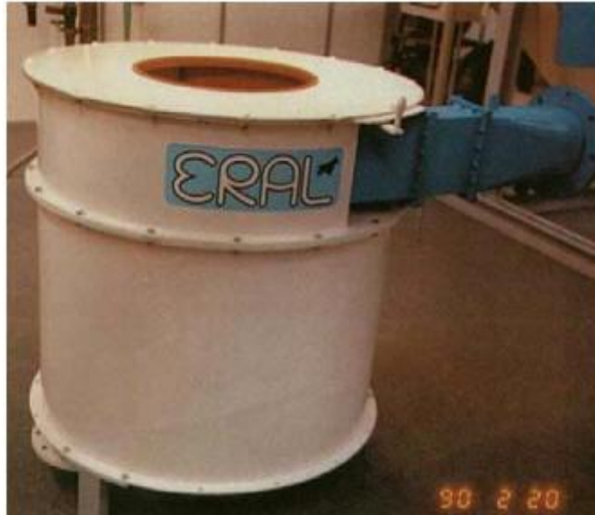
Figura 2.20 Criba centrífuga ZS 600 o Ciclón Criba
