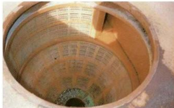
Figura 2.21 Vista interior de la Criba Centrífuga ZS 1000
