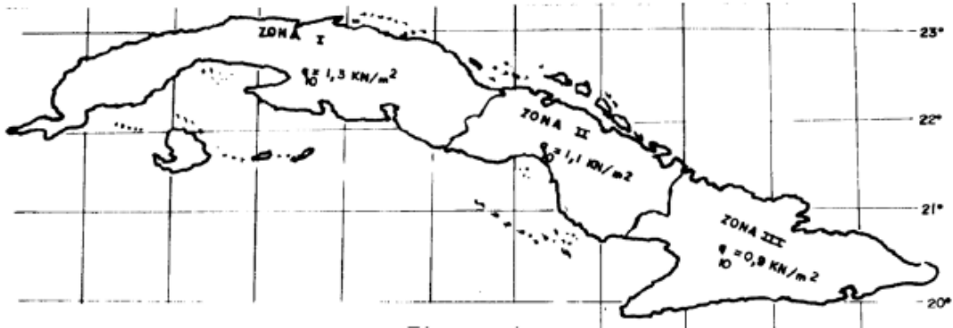
Figura 1.1 Regionalización según la ubicación de la construcción
