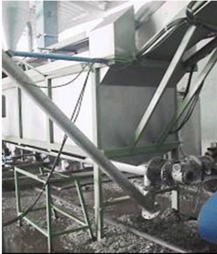
Figura 2.15 Bañera de la Planta de Plástico Mixto de Cienfuegos para separar los plásticos de diferentes densidades.
