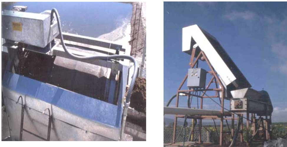
Figura 1.6 Separador de pantallas estacionarias o cribas. Fuente: (Peralta, 2005).
