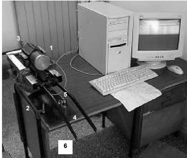
Figura 6. Instalación experimental durante la calibración estática del sistema.
