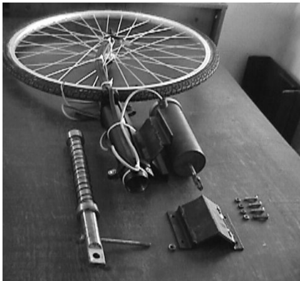
Figura 3. Vista de algunos mecanismos del sistema de medición del coeficiente de resistencia del camino.
