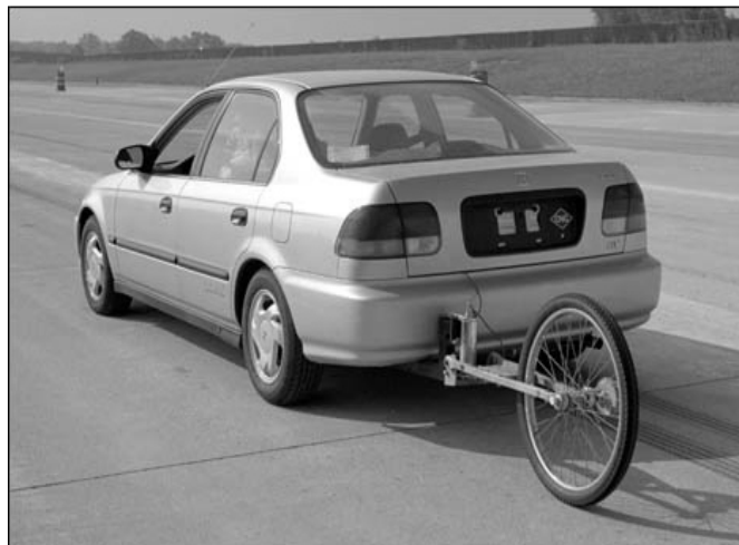
Figura 49. La quinta rueda " Dynamics Evaluations, Inc " arrastrada por un vehículo ligero [66] .
