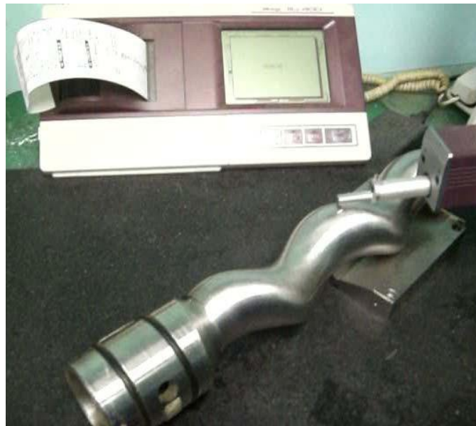
Figura 3.23. Medición de la rugosidad superficial realizada a uno de los rotores después de la pasada de acabado en el dispositivo especial.
