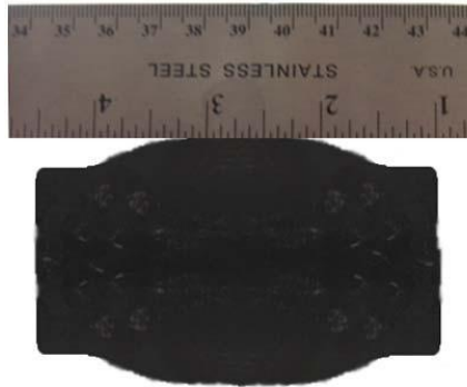
Figura 3.19. Resultado de la deformación del tubo para p = 6,83 MPa.
