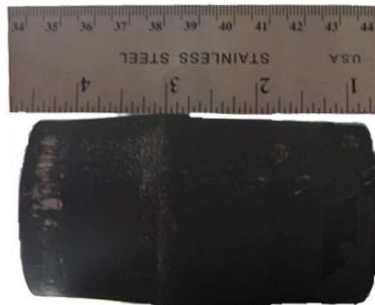
Figura 3.18. Resultado de la deformación del tubo para p < 6,83 MPa.
