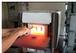
Figura 3.14. Calentamiento del tubo en la mufla.
