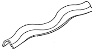
Figura 1.12. Plancha conformada utilizada en la fabricación del rotor (Gunther, 1981).
