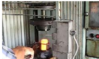
Figura 3.15. Colocación del tubo en el molde.
