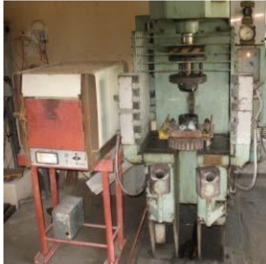
Figura 3.10. Vista panorámica del equipamiento para la deformación en caliente de un tubo de acero inoxidable.
