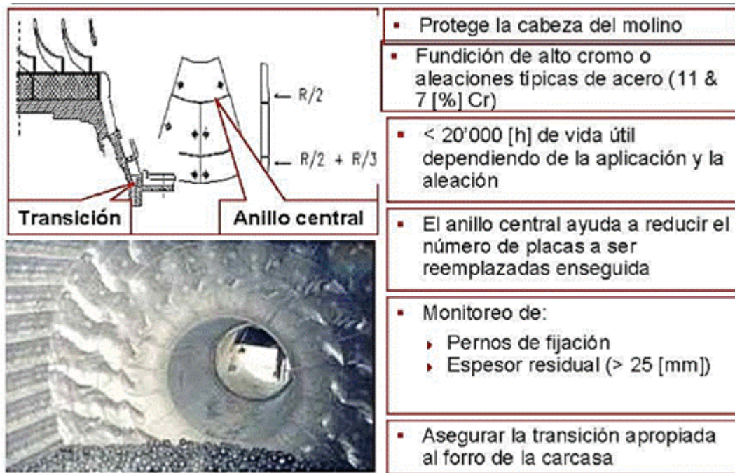
Figura 3.6 Estructura, material y funciones de las Cabeceras de Alimentación. (Fuente: Polysius Cemento, 2013)
