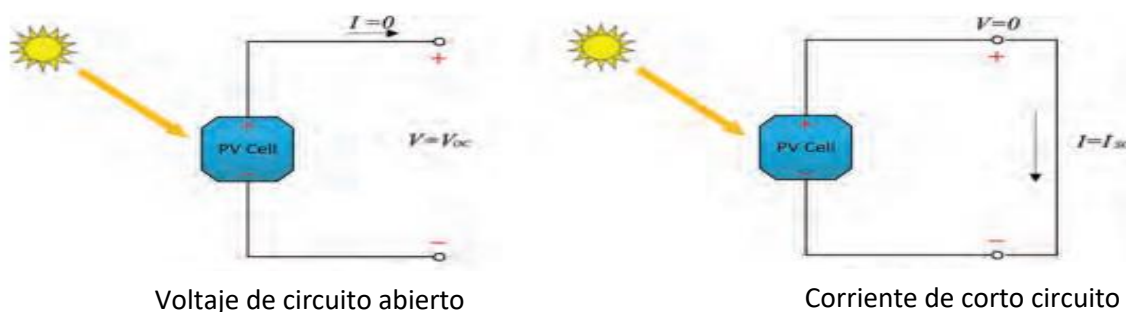
Figura: 2.5. Modelo de un circuito ideal de una celda FV. Fuente: (Tanrioven, 2023)
